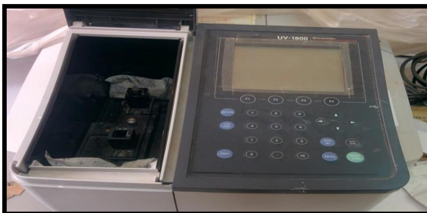
Figure III. 14 : Dispositif expérimental de spectroscopie UV-visible utilisé (laboratoire des matériaux organiques. Université EchahidHamma Lakhdar).
