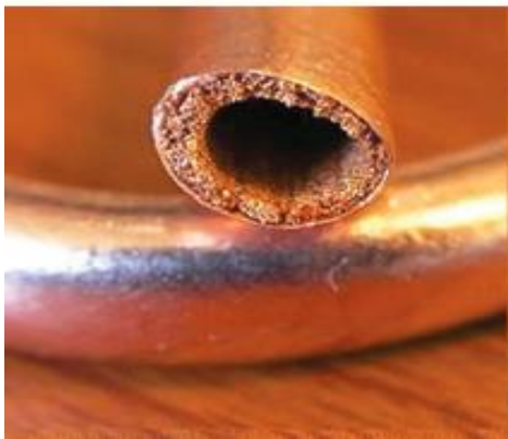
Figure 0-2: Mèche frittée en poudre métallique.
