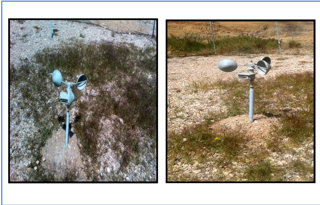
Figure 4. Anémomètre totalisateur du barrage de Fontaine des Gazelles. (Laouni et Bettahar, 2017)
