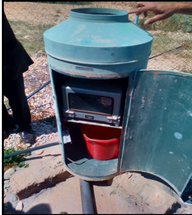
Figure 2. Pluviomètre de mesure des pluies du barrage de Fontaine des Gazelles (Pluviomètre manuelle) (Laouni et Bettahar ,2017).
