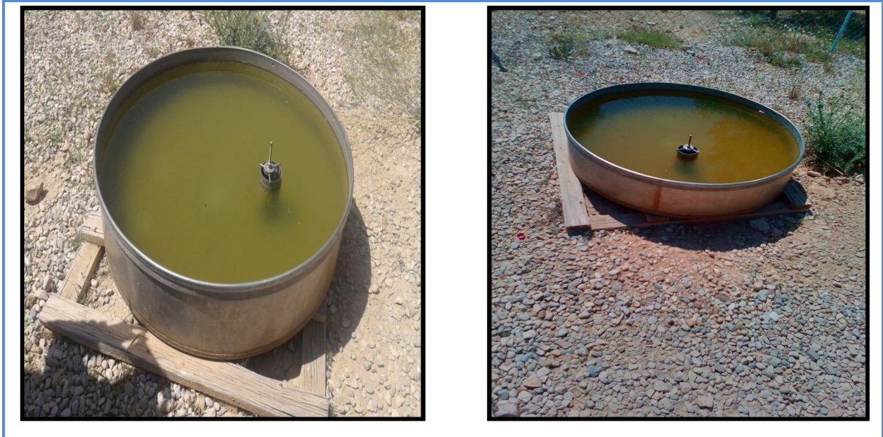
Figure 6. Un bac d'évaporation classe- A- du barrage de Fontaine des Gazelles (Laouni et Bettahar ,2017).
