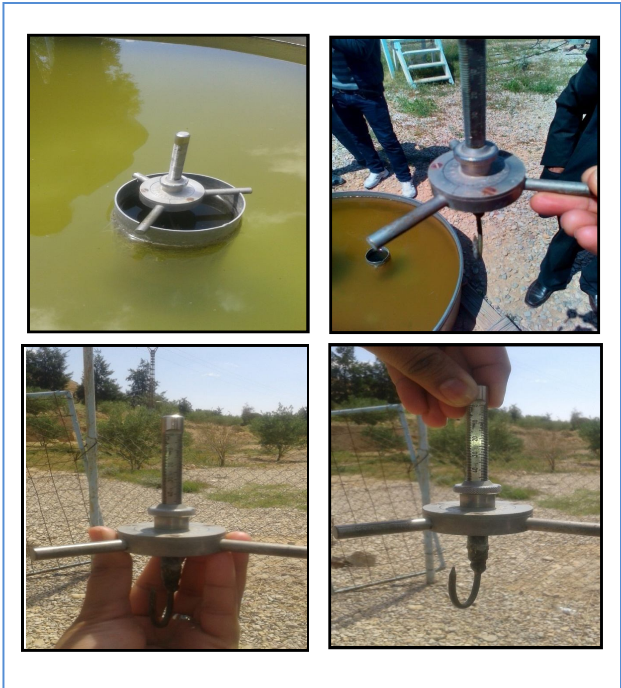
Figure 7. La règle de mesure de l'évaporation dans le bac class A (Laouni et Berttahr, 2017).
