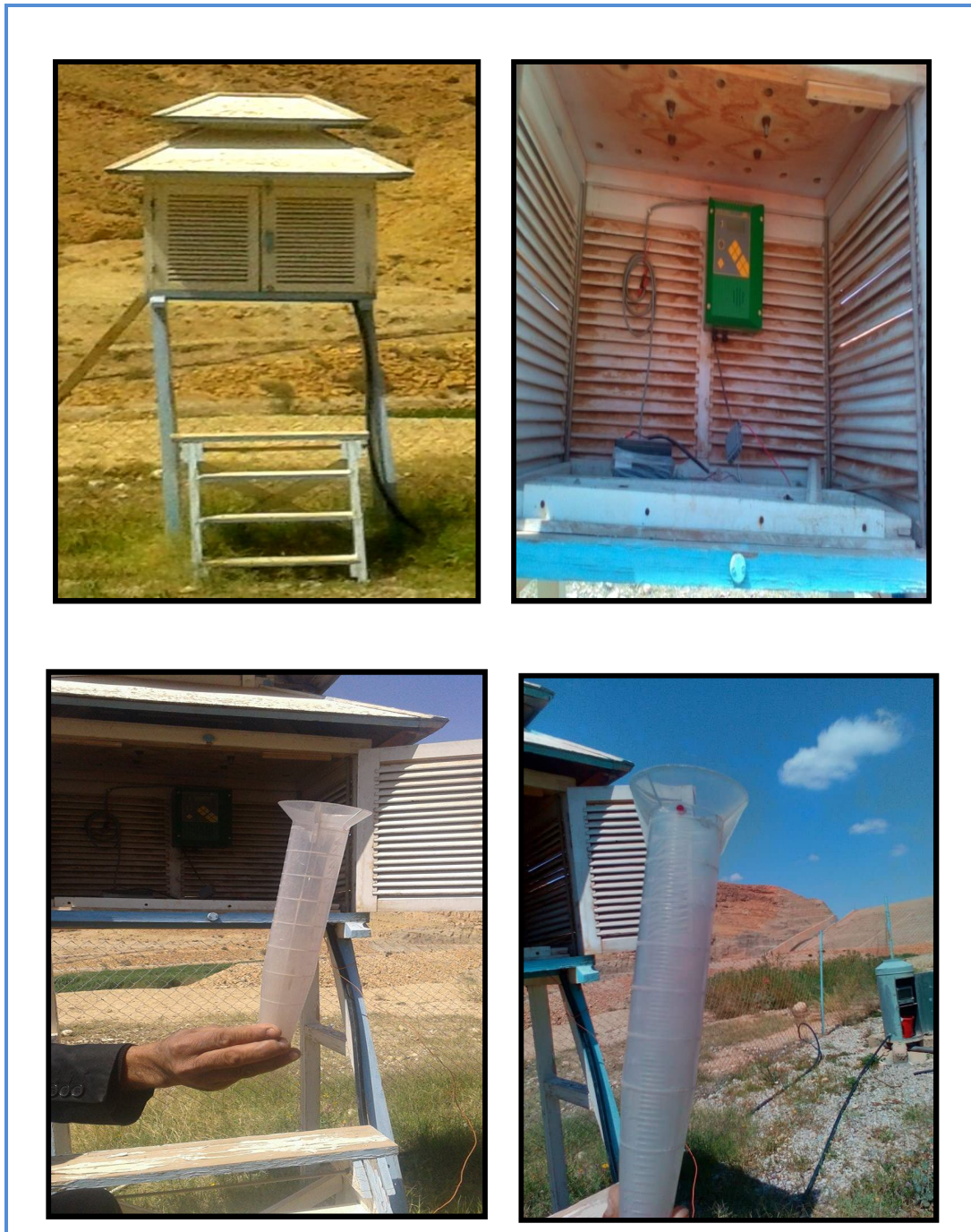
Figure 3. Abri météorologique du barrage de Fontaine des Gazelles (Pluviomètre automatique) ; (Laouni et Bettahar, 2017)
