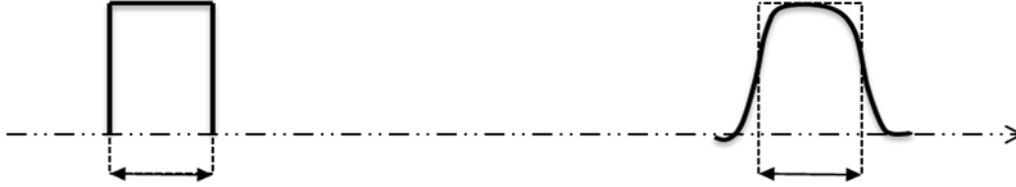
Figure 2. 6: Effet de la dispersion chromatique : le signal qui se propage s'élargit.
