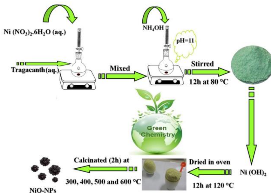
Figure VI.2 : Schéma de biosynthèse de nanosheets de NiO stabilisés par la tragacanthé [1].
