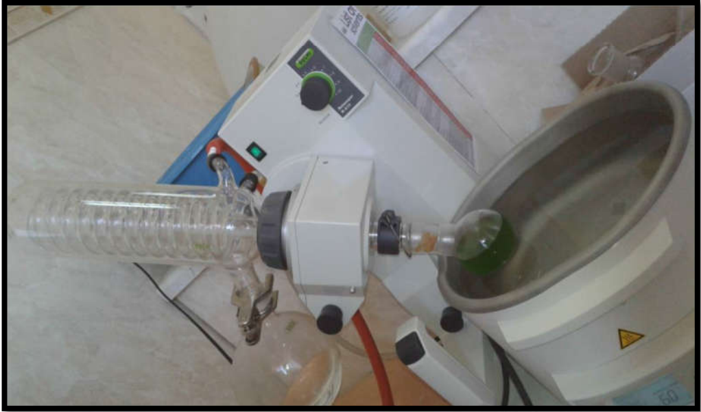
الملحق رقم (09): جهاز التبخير الدوار .
