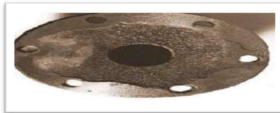
الشكل (IV-7): صورة للتآكل التصدي.
