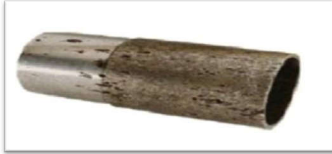
الشكل (IV-8): صورة التآكل الموضعي.
