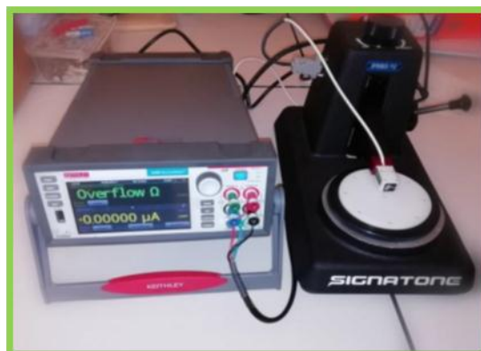
الشكل (II-22): تركيبية تقنية النقاط الأربعة [56]، والجهاز المستعمل في القياس (Signatone). 12-II- المعالجة الحرارية للأغشية:
