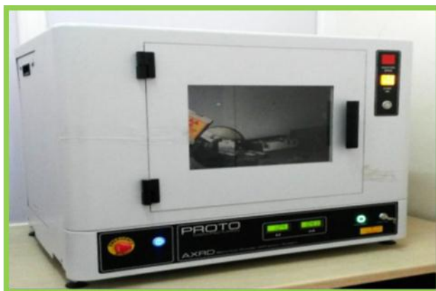
الشكل (II-13): جهاز إنعراج الأشعة السينية (XRD) المستخدم [21].
