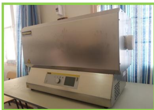
الشكل (III-23): فرن المعالجة الحرارية.
