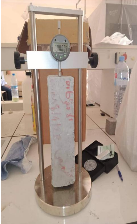
الملحق رقم 13 : قياس قيمة الانكماش لعينة بجهاز قياس الانكماش
