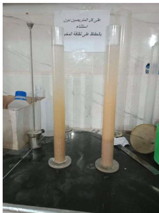
الصورة (4-III) توضح تجربة مكافئ الرملي بعد الرج و بعد عشرين دقيقة للرملين
