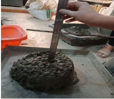
صورة (1-IV) توضح هبوط الخرسانة في اختبار مخروط أبرامس
