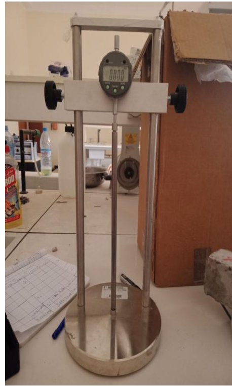
الملحق رقم 13 : قياس قيمة الانكماش لعينة بجهاز قياس الانكماش
