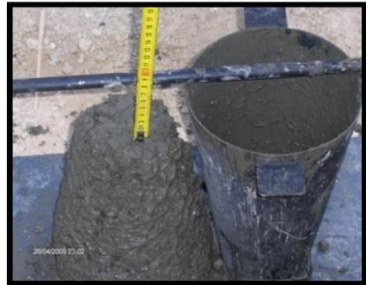
صورة (1-IV) توضح هبوط الخرسانة في اختبار مخروط أبرامس
