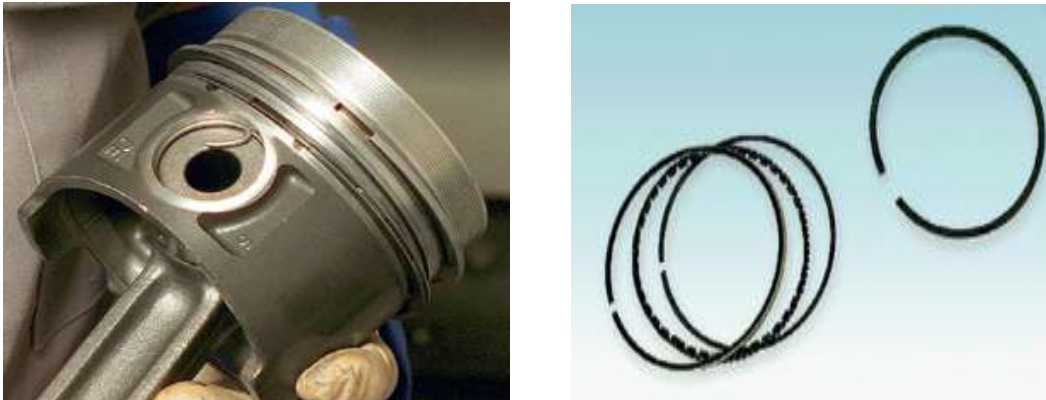
Figure. I.8. Les segments et leur position dans le piston [5]
