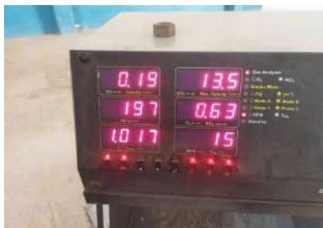
Figure. IV.5. L'écran affiche le résultat de l'analyse des gaz d'un moteur de voiture
