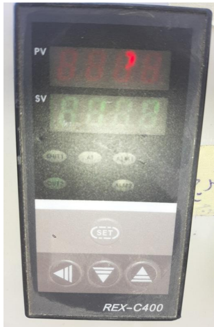
Photo (III.15) : Dispositif de contrôleur de température intelligent mode REX-C400.
