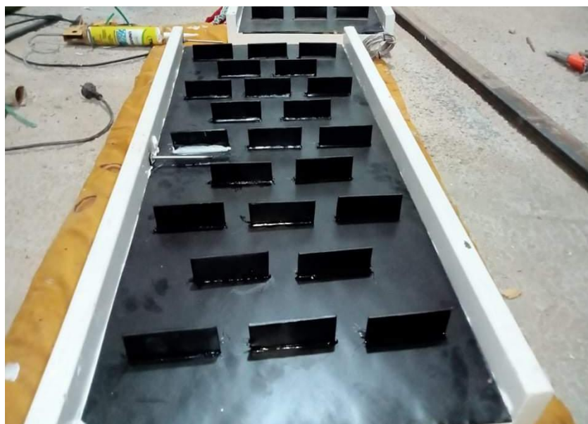
Photo (III.11) : Capteur solaire avec chicanes transversales.
