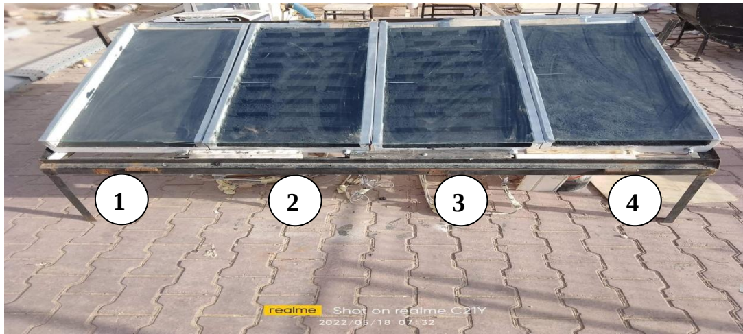
Photos (III.1) : Les quatre capteurs solaires à réaliser.
