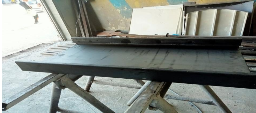
Photo (III.7) : Coffre du capteur.
