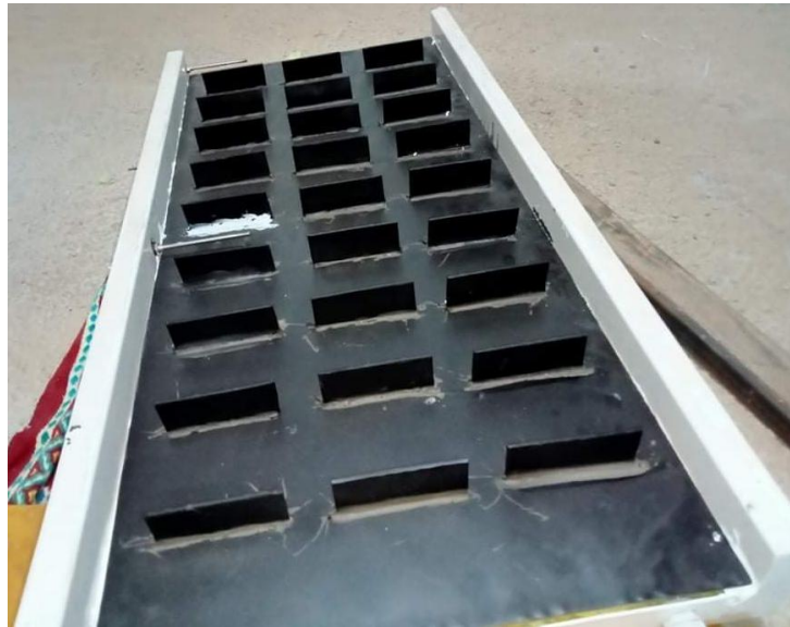
Photo (III.10) : Capteur solaire avec chicanes parallèles.
