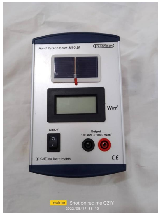
Photo (III.26) : Pyranomètre (Pyranometer 4890.20 "Frederiksen").
