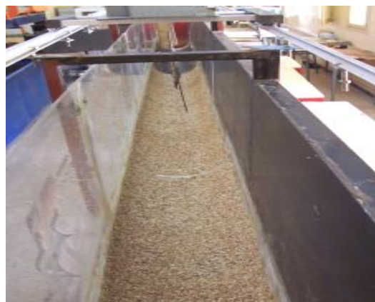
Photo 3.3 : a) échantillon de grains de gravier de rugosité équivalente \epsilon = 5,63\text{mm} b) Grains de gravier répartis uniformément sur le fond du canal.
