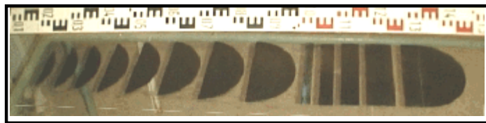
Photo 3.1 : Série de seuils minces ayant servi au contrôle du ressaut.
