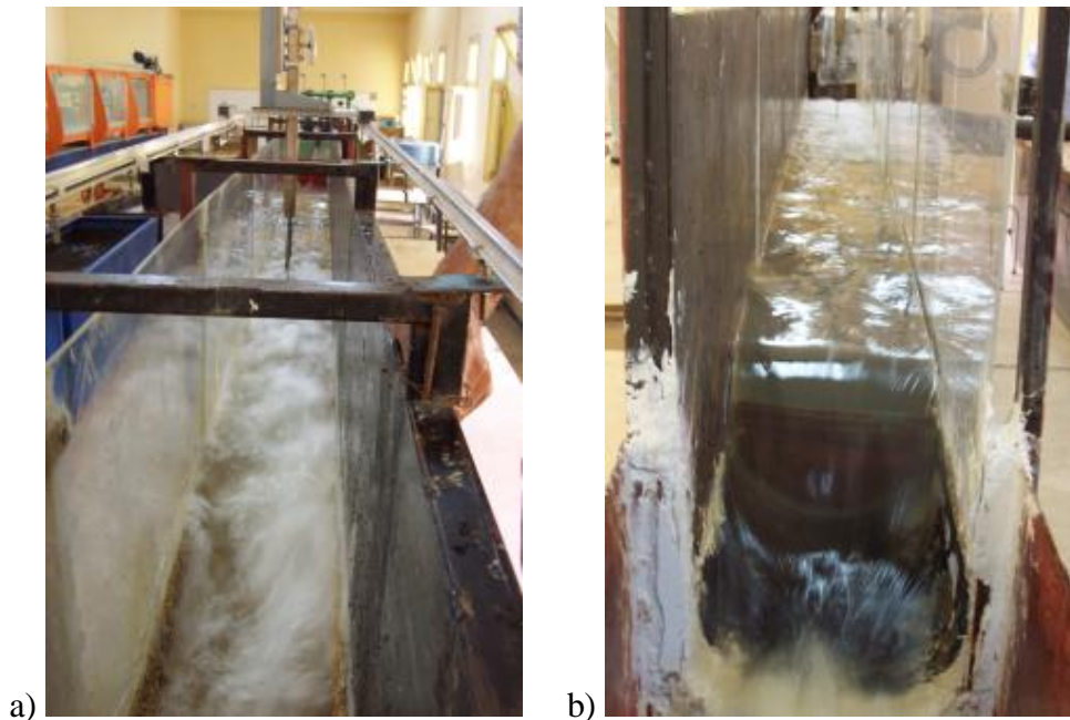
Photo3.2 : Ressaut hydraulique évoluant dans un canal profilé en U à fond rugueux.
