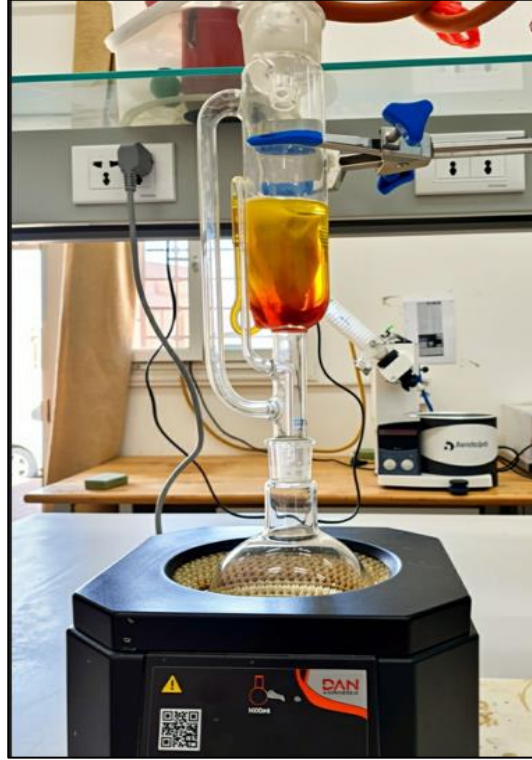
الصورة (9): تركيب سوكسلي للاستخلاص.
