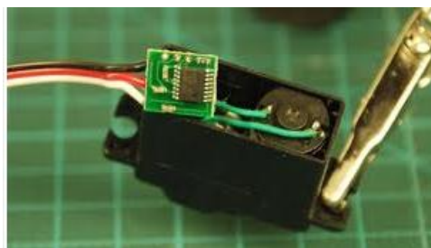
Figure II.10 Circuit de commande du servomoteur.
