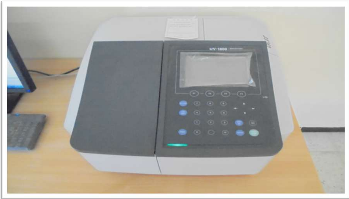
الوثيقة: جهاز المطيافية الضوئية (Spectrophotomètre).
