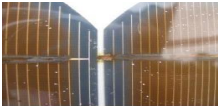
Figure II-3: Corrosion dans les interconnexions de cellules de jeu de barre
