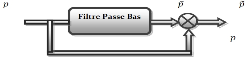
Figure 17 Structure d'un filtre passe-bas
