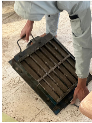
FIGURE II.10 – Remplissage à moitié et vibration
