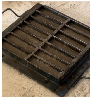
FIGURE II.9 – Remplissage à moitié et vibration
