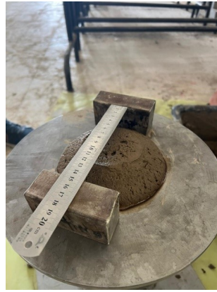
FIGURE II.12 – Dispositif de mesure d'affaissement au table de secus
