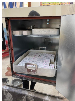
FIGURE II.15 – Mise à l'étuve des éprouvettes à une température de 105°
