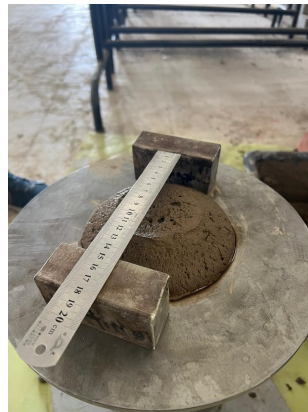
FIGURE II.13 – Dispositif de mesure d'affaissement au table de secus
