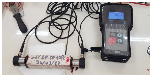
FIGURE II.18 – Mesure de la vitesse de propagation de sons sur des éprouvettes (4x4x16) cm 3
