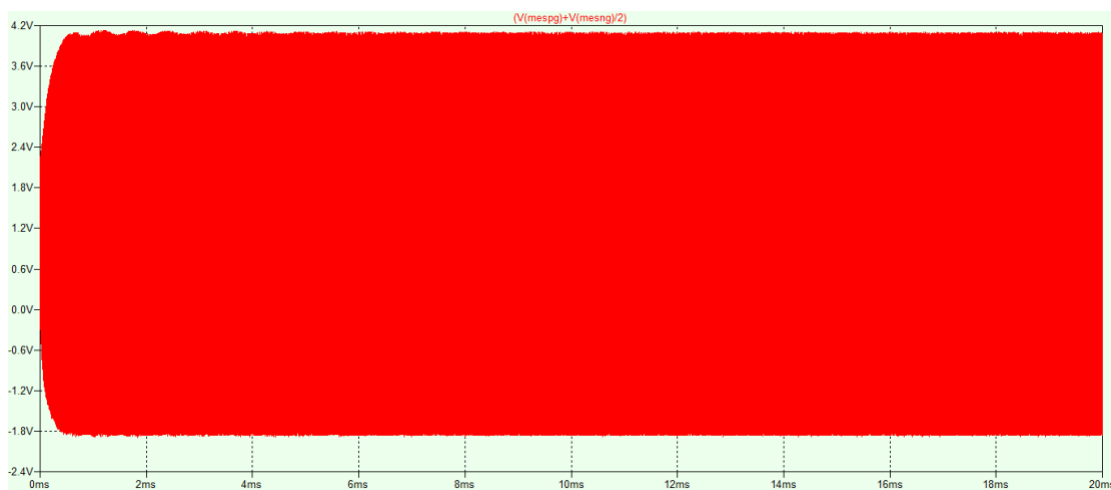
Fig .II.7. Tension temporelle aux bornes RSIL en mode commun V_{MC}
