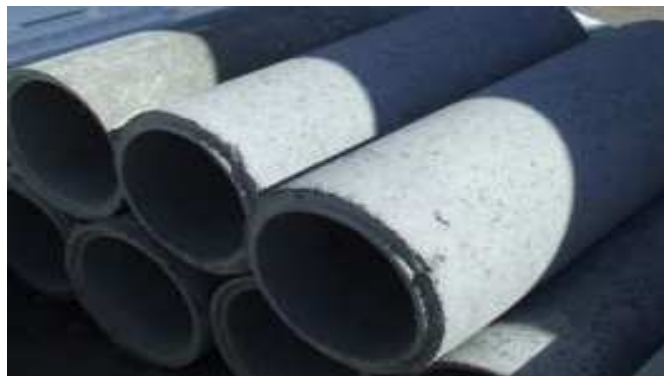
Photo V.1 : Conduites en béton non armé.
