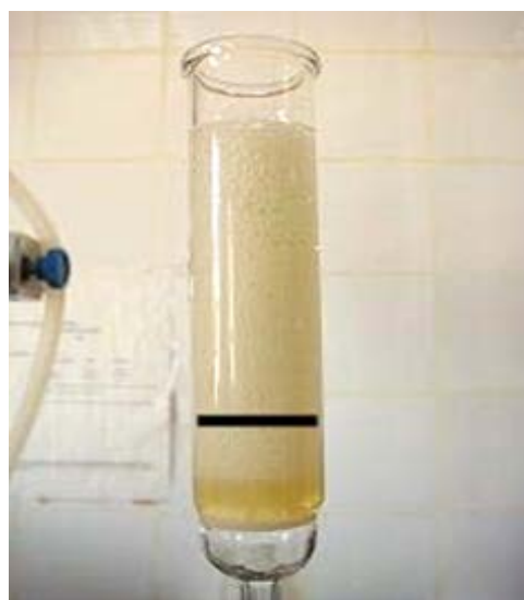
Figure 10: Test de moussage d'amine pauvre avec l'Inhibiteur de Corrosion ECM 54A
