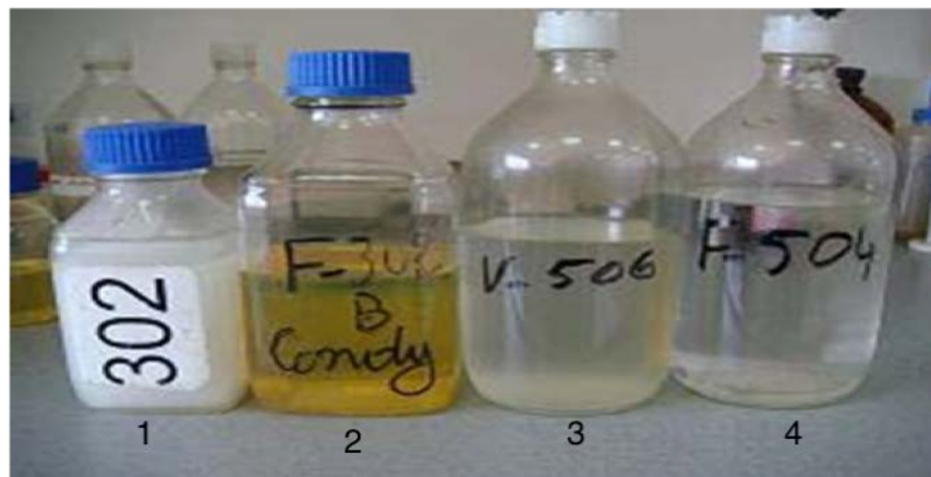
Figure 3: Fluides issue des séparateurs d'admission - Usine d'Ohanet
