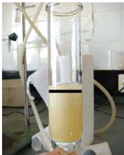
Figure 8: Test de moussage d'amine Pauvre sans contaminant
