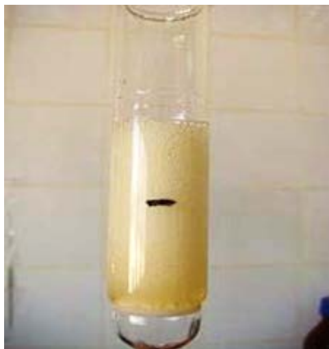
Figure 9: Test de moussage d'amine pauvre avec hydrocarbures F-504
