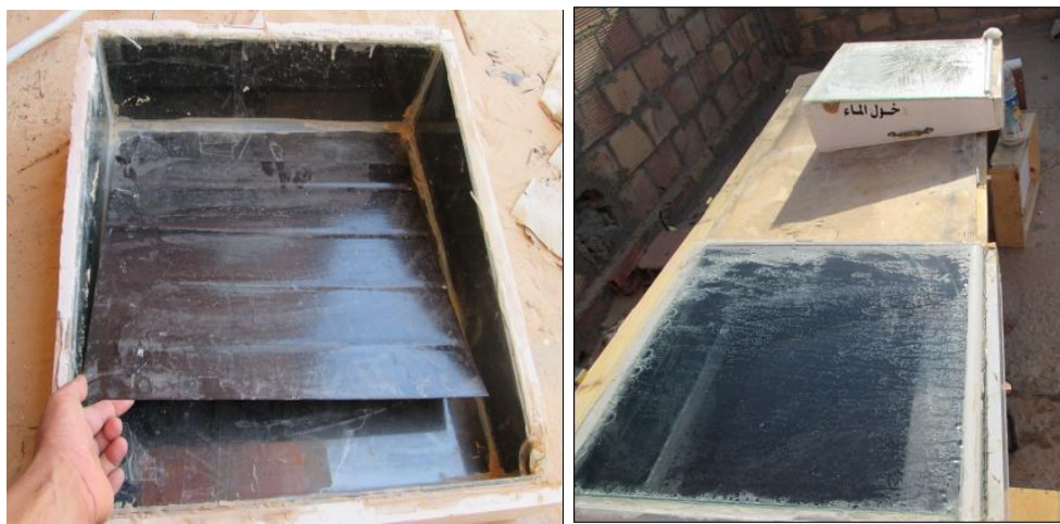
Fig. 3.18. Distillateur avec l'absorbeur
