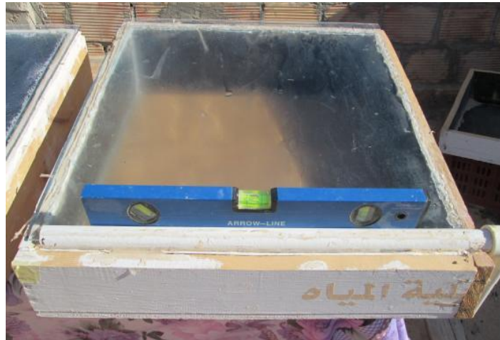
Fig. 3.17. Distillateur avec un milieu poreux (sable fin)
