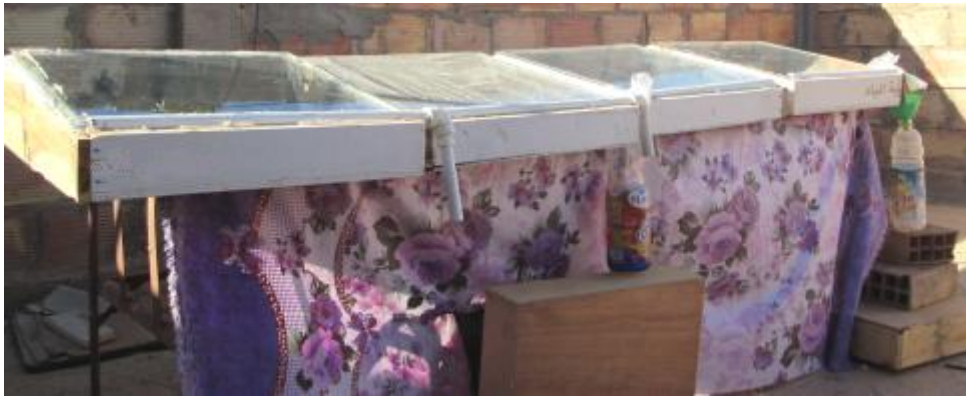
Fig. 3.13. Les quatre distillateurs en cours de préparation
