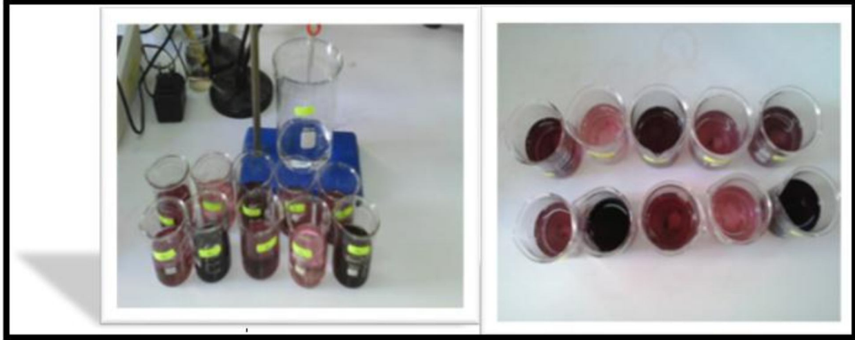
صورة 11: المعايرة لقياس العسرة الكلية للماء
