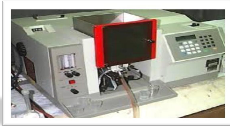
صورة 8: جهاز الامتصاص الذري باللهب
