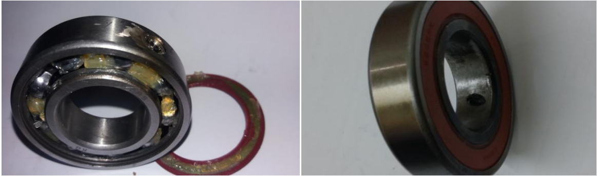
Figure (III.2): Photos d'un roulement défectueux dans la BE et BI.
