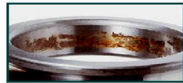
Figure (II.7): Corrosion de contact sur la bague Intérieure d'un roulement à rouleaux sphérique[ADB 10].
