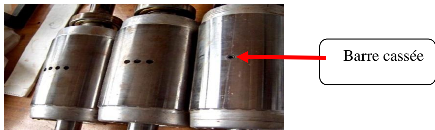
Figure (I.19) : Photo des barres cassées[BES 17].
