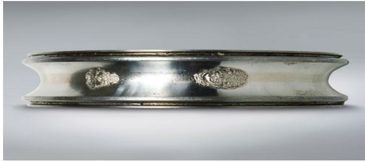
Figure (II.6): PhotosEcaillage de fatigue sur la d'un roulement dans la BE[ADB 10].
