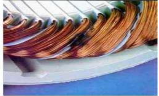
Court-circuit dans une phase
