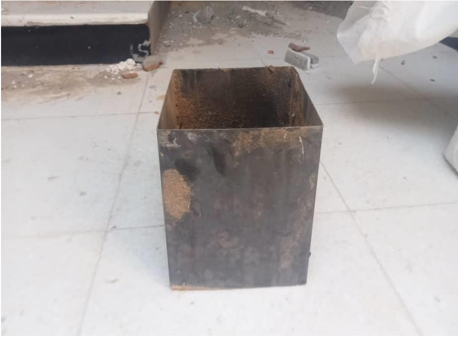
الملحق (IV-1) يوضح قوالب عينات تجربة النفاذية
