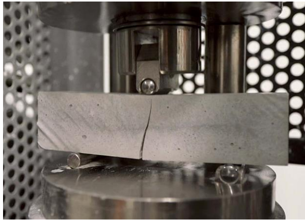
الصورة 1 . 3 توضح وضع العينة داخل جهاز الشد بالانحناء بتعريض العينة لقوى واحدة مركزية.
