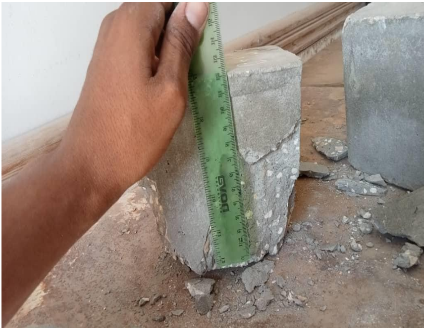
الملحق (IV-2) عمق تسرب الماء في عينة النفاذية
