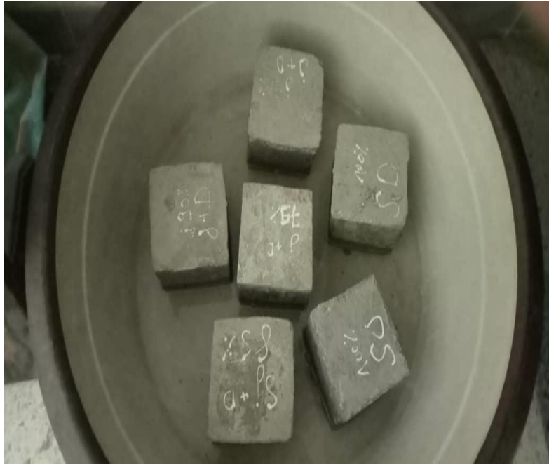
الصورة IV. 2 توضح تجربة الامتصاص
