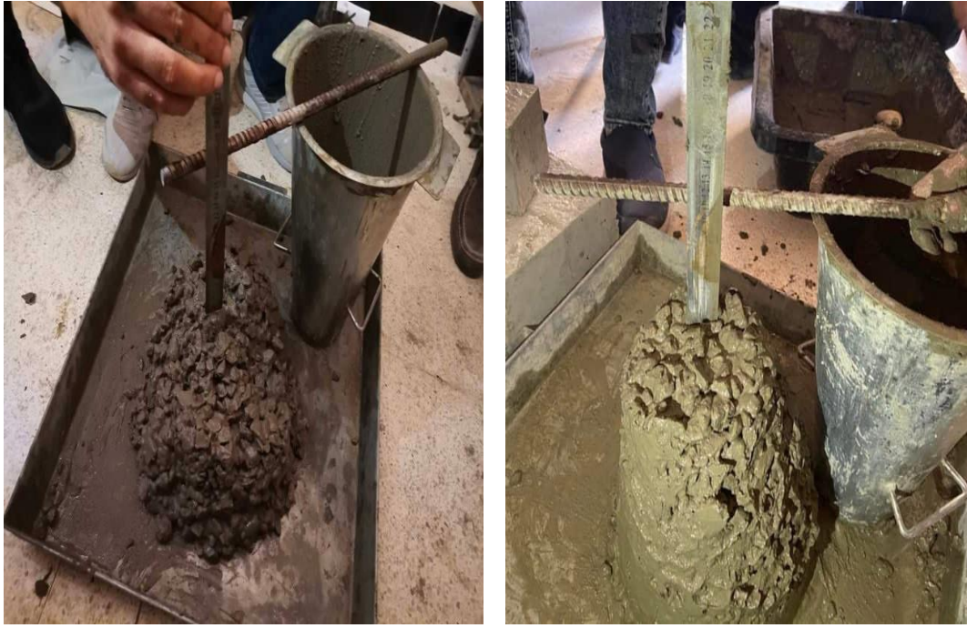
الصورة 1. IV. توضح خطوات اختبار مخروط ابرامس
