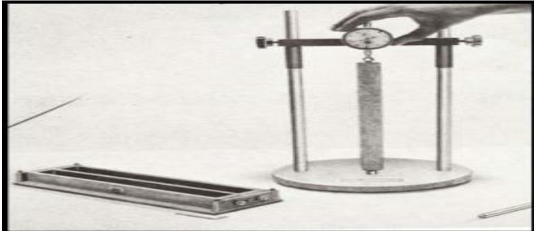
الصورة ١ . 5 جهاز عملية الانكماش
