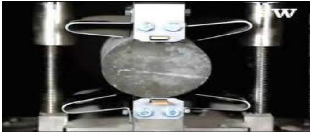
الصورة | 2 . الصورة توضح طريقة وضع العينة داخل جهاز الشد الغير مباشر.
