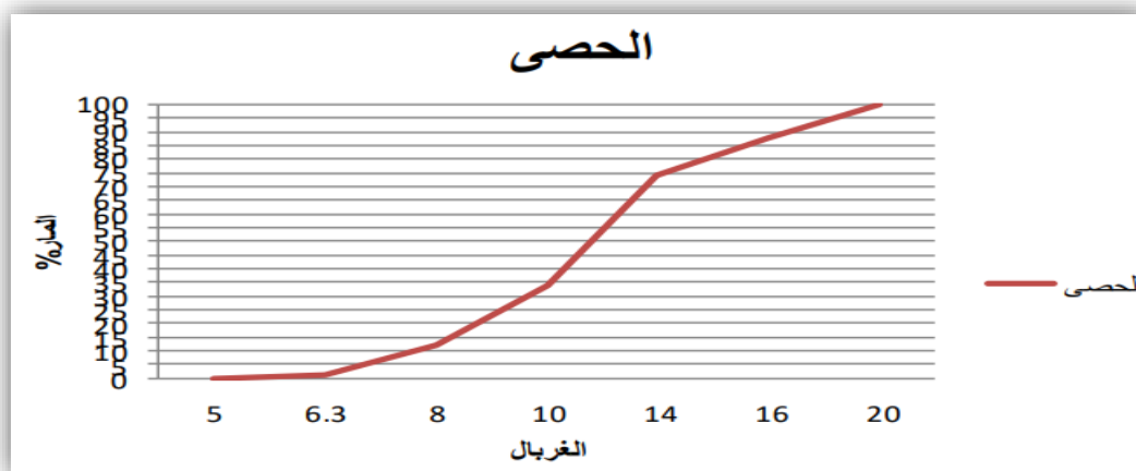
الرسم البياني III. 7 يوضح التحليل الحبيبي للحصى (15/8)
