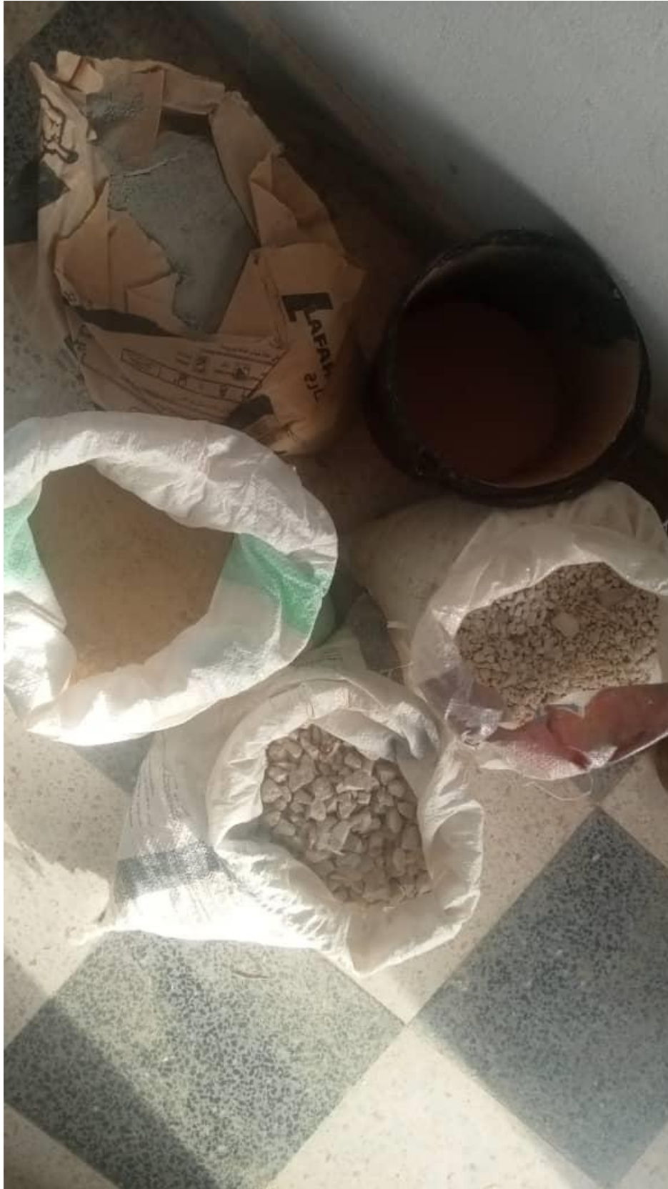
الملحق (2-III) يوضح المواد المستعملة في التركيبة الخرسانة
