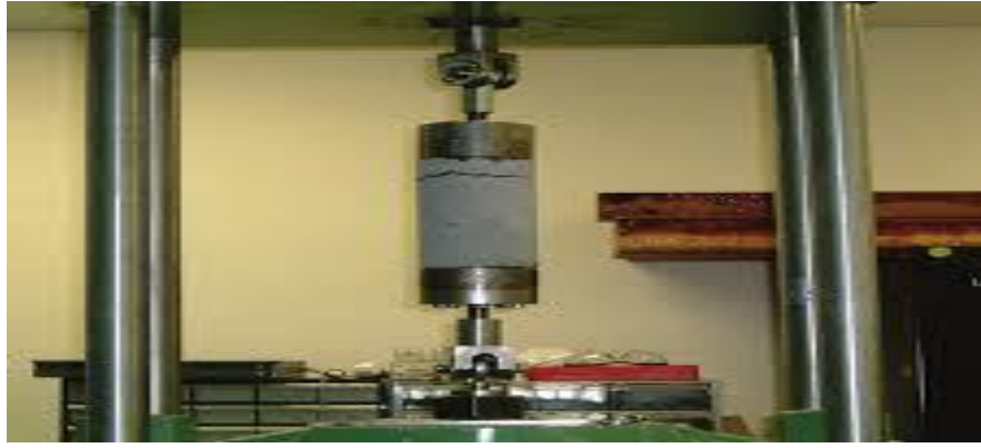
الصورة | 1 . توضح طريقة وضع العينة داخل جهاز الشد المباشر.
