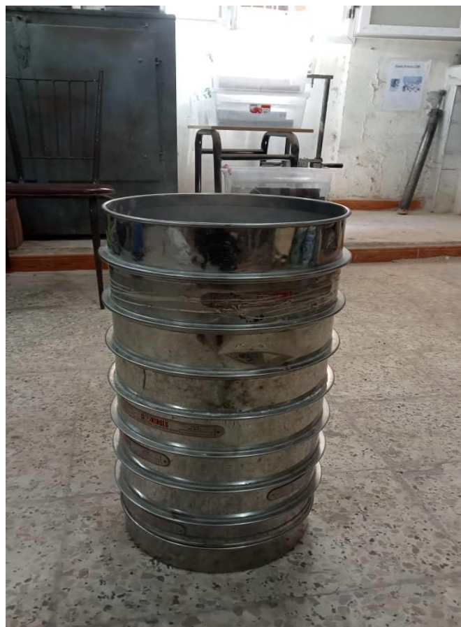
الصورة III. 1 توضح الغريل المستخدمة في تحليل الحبيبي
