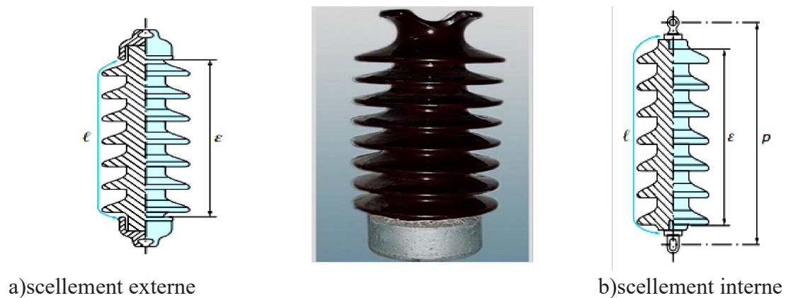
Figure I.4 Isolateur à long fût en porcelaine céramique
