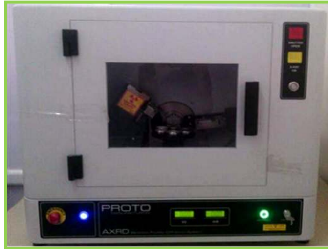
الشكل (III-7): جهاز الانعراج الآلي من نوع PROTO AXRD Benchtop.
