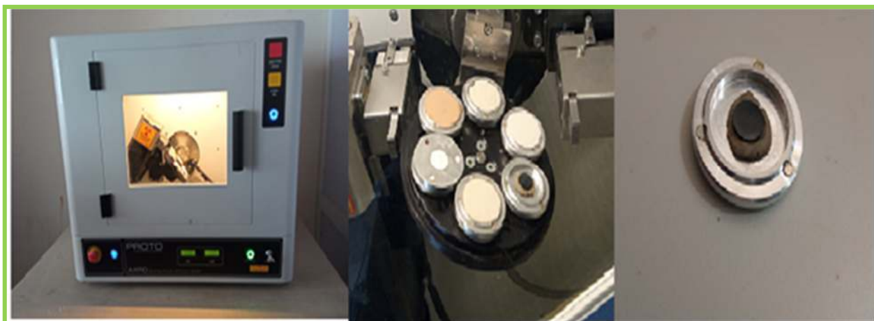
الشكل (III-8): أدوات تحضير العينة للقياس بواسطة جهاز الانعراج.
