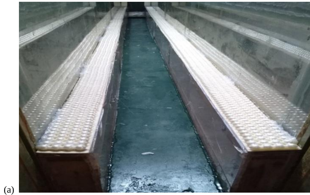
Figure I.10: Photographie des tapis rugueux imposés au lit majeur du canal composé .a) canal avec fond lisse. et avec lit majeur rugueux (Laboratoire Université Ouargla).
