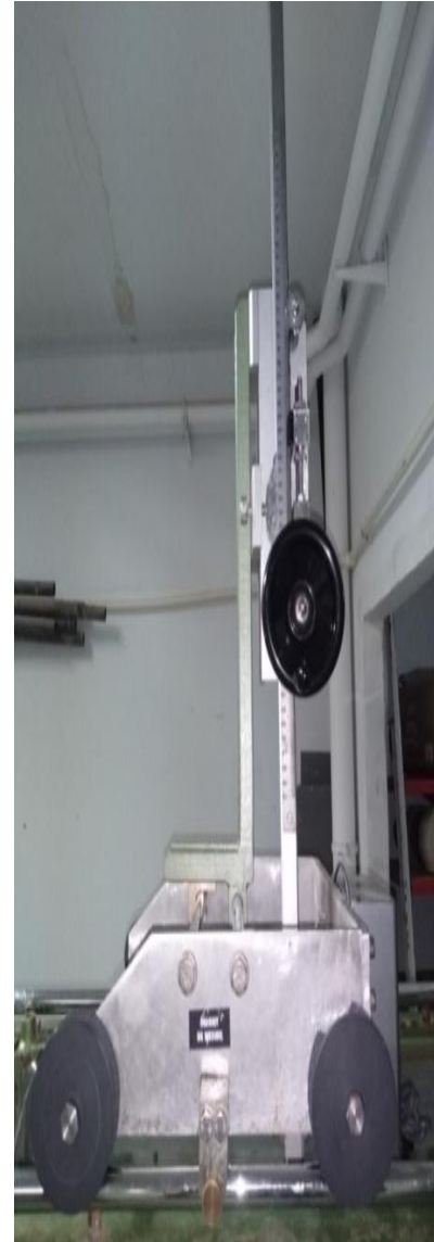
Figure I.6: La profondeur d'eau mesurée par pointe limnimétrique (Laboratoire Université Ouargla).
