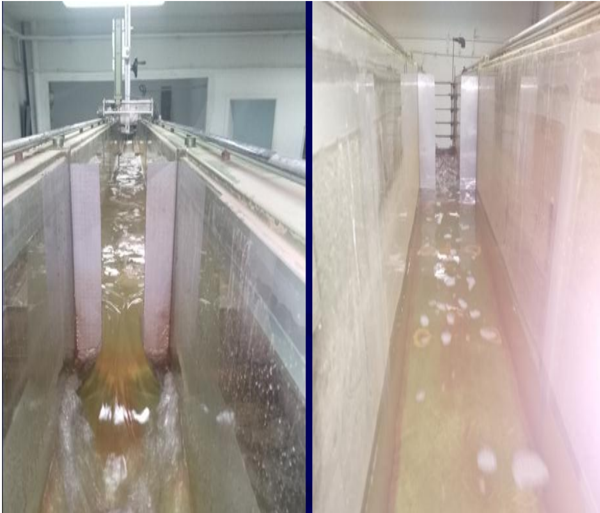
Figure I.4: Photographie du déversoir rectangulaire avec contraction latérale pour mesurer les débits pompés (Laboratoire Université Ouargla).
