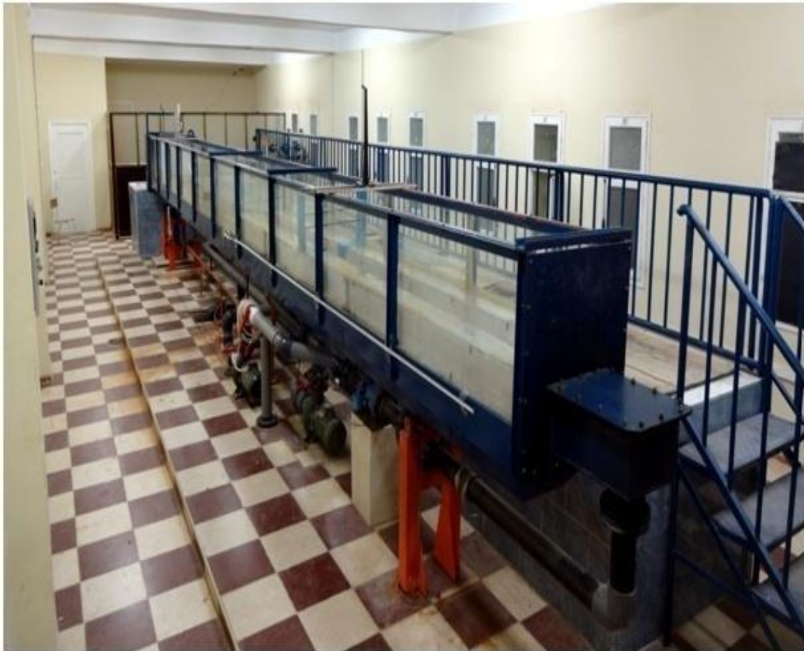
Figure II. 2: Photographie du canal ayant servi à l'expérimentation (laboratoire larhyss de Biskra)
