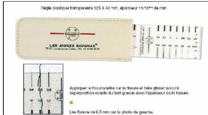
Photo (II, 4): Fissuromètre.
