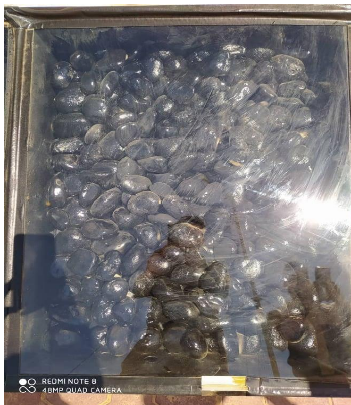
Fig III.3 collecteur soutenu par pierre silex du Biskra.
