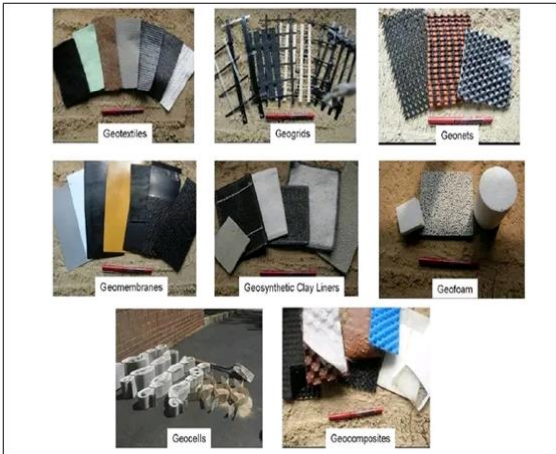
Figure I.15 : Les principes types de géosynthétique
