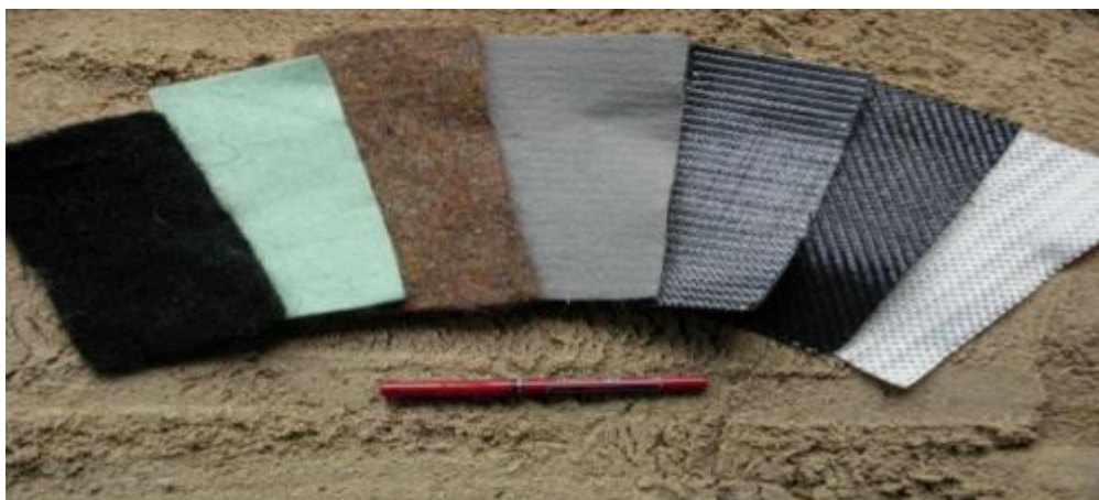
Figure I.16 : Différents types de géosynthétique[6]
