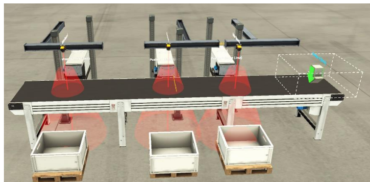
Figure III.7 Le montage sur factory I/O
