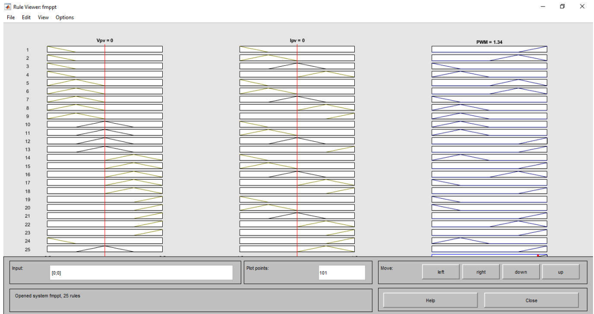
Figure (a). La fenêtre « Ruleviewer » du contrôleur MPPT flou sur Matlab.
