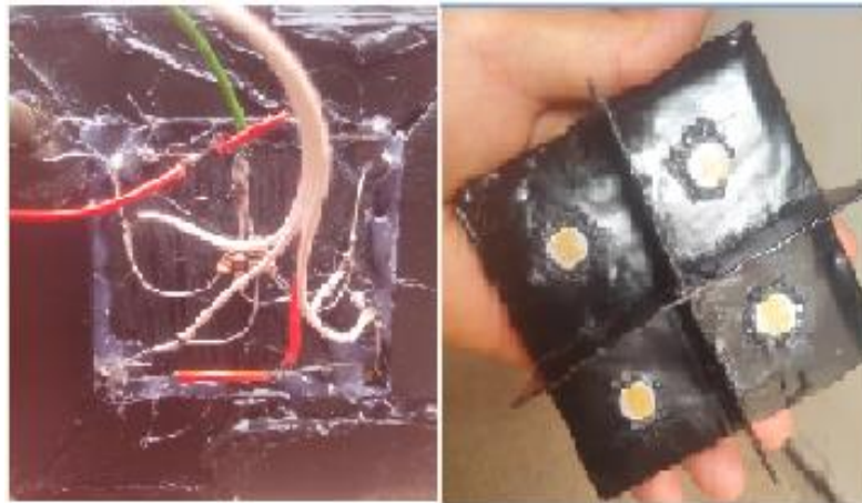
Figure.III.13. Photo de Réalisation du circuit électrique du capteur solaire.
