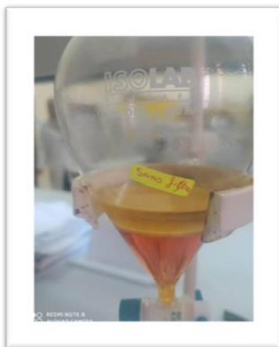
Figure 21 : Montage de cristallisation
