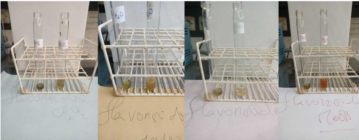
الشكل IV-23: المحاليل بعد اضافة HCl و Mg .
