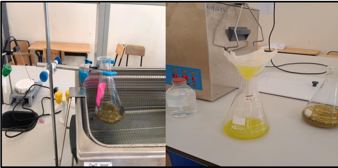
الشكل IV-5: استخلاص بجهاز ultrason و ترشيح العينة.
