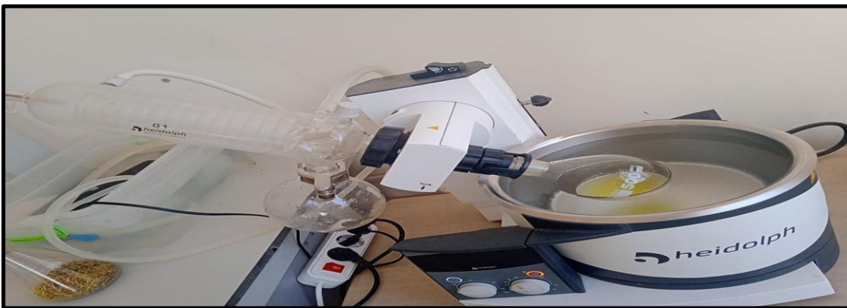
الشكل IV-6: تبخير المستخلص بجهاز Rota vapour
