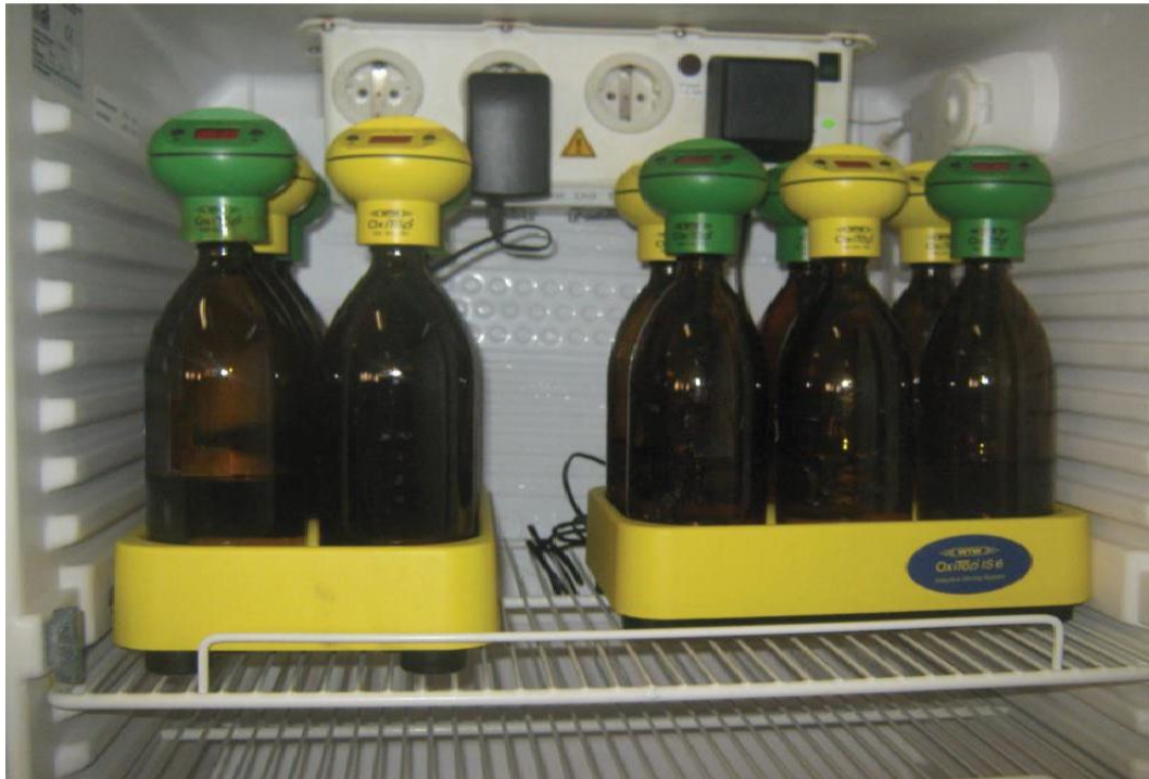
Photo.16: DBO mètre pour la détermination de DBO 5 .
