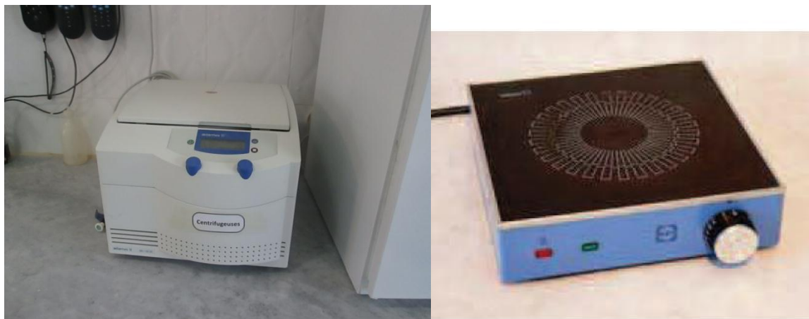
Photo.14: les appareils utilisés pour la détermination de MES (centrifugeuse .Plaque chauffante).
