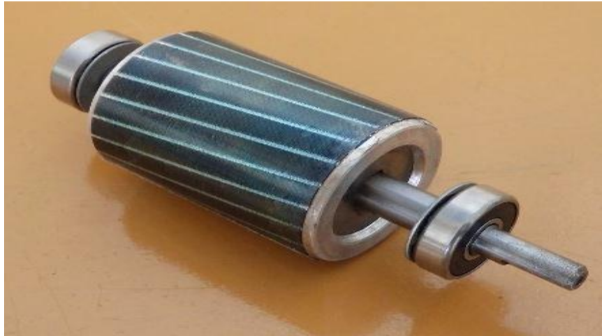
Figure (I-2) : rotor d'un moteur asynchrone
