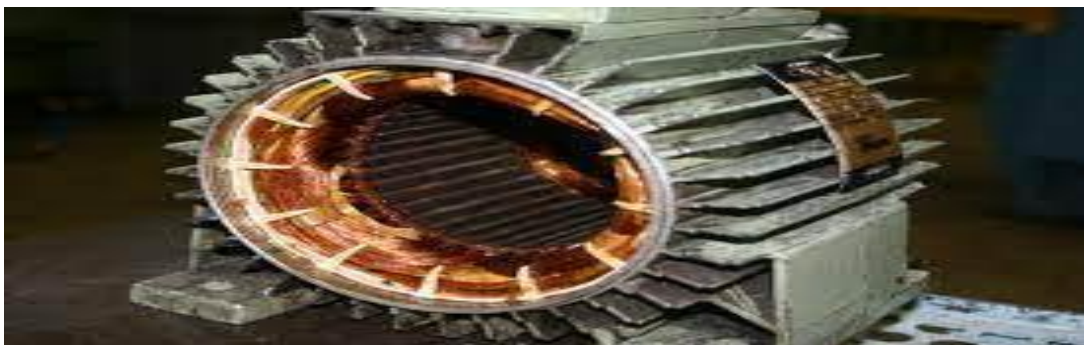
Figure (I-3) : Stator d'un moteur asynchrone
