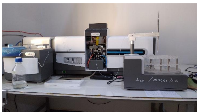
الشكل (8.IV): التحليل الطيفي للامتصاص الذري.
