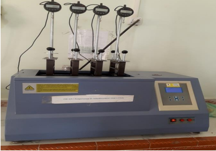
صورة رقم 14: جهاز نقطة التلين (Vicat).
