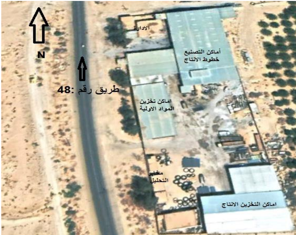
صورة رقم 5: توضح أقسام مصنع دليبة للأنابيب البلاستيكية.
