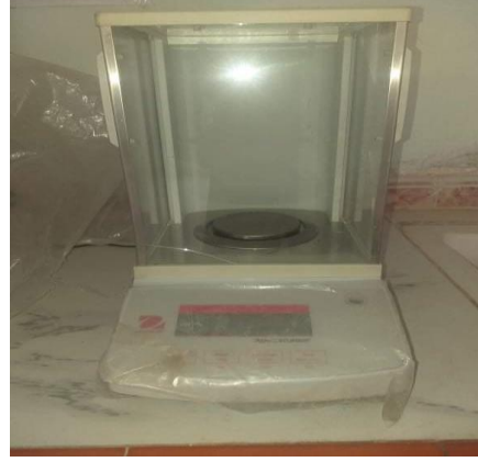
صورة رقم 9: جهاز تعيين الكثافة
