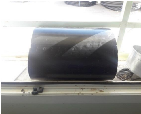
صورة رقم 12: عينة لاختبار التمدد الحراري.
