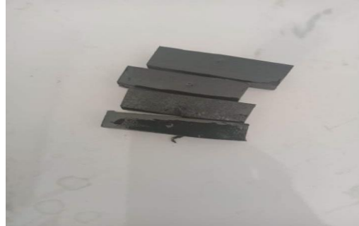
صورة رقم 25: عينات اختبار التلين الحراري.
