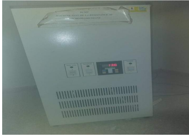
صورة رقم 13: جهاز اختبار ثنائي الكلوروميثان.
