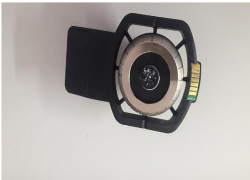
صورة رقم 23: حامل العينة لجهاز (SEM)
