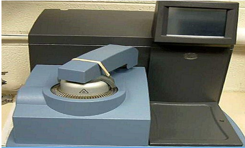
صورة رقم 4: جهاز المسح المسعري التفاضلي (DSC)
