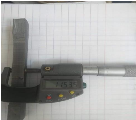
صورة رقم 8: أداة قياس السمك الميكرومتر (Micromètre)
