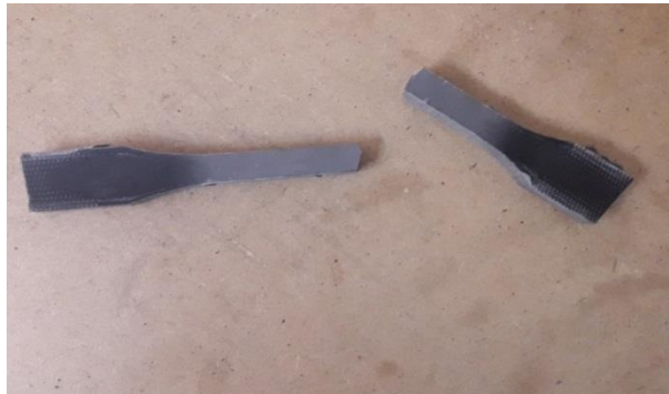
صورة رقم 28: عينة بعد اجتياز اختبار الشد والاستطالة.
