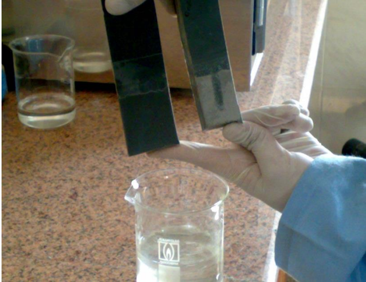
صورة رقم 3: تظهر تأثير محلول (ثنائي الكلوروميثان) على عينة من PVC U-[41].
