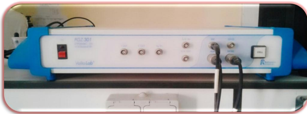
شكل رقم 17: صورة فوتوغرافية لجهاز potentiostat من نوع PGZ 301
