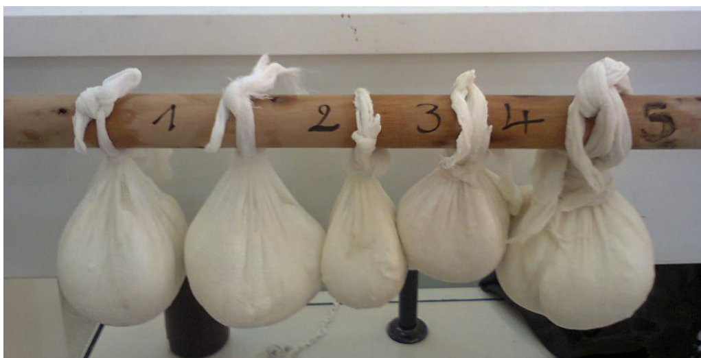
Figure 33 : Egouttage de cinq échantillons.
