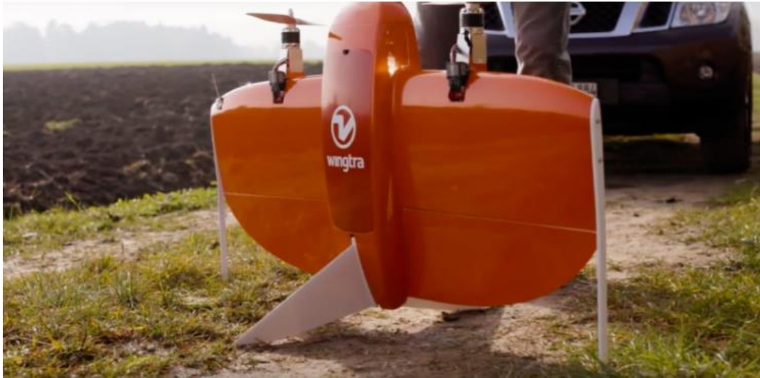
Figure I.3: Drone à voilure fixe WingtraOne utilisé pour les applications de cartographie et de topographie de haute précision[20].
