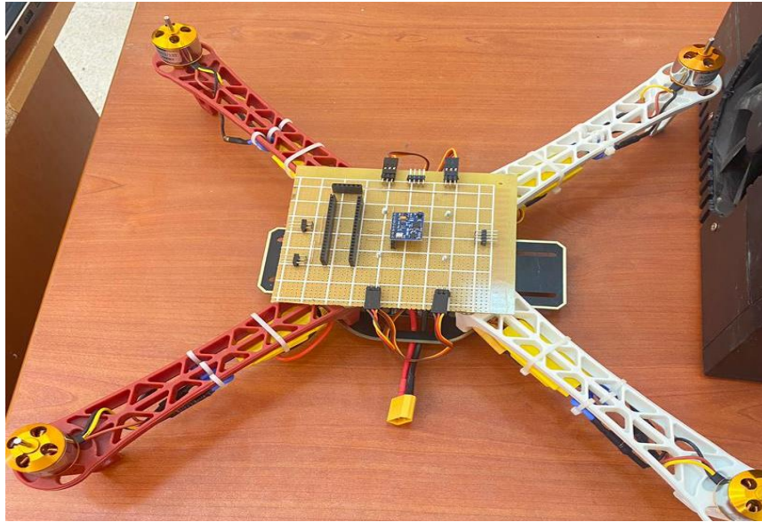
Figure III.19 : Montage des ESC et moteurs
