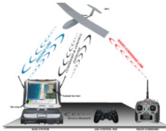
Figure I.6: Schéma d'un système de drone avec unité de contrôle[31].
