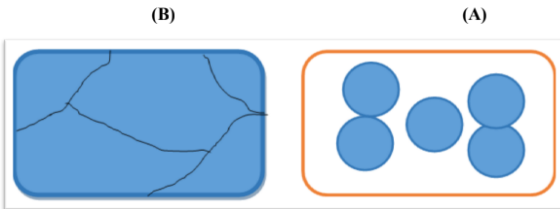
الشكل (II-8): رسم تخطيطي يوضح مرحلة نمو (A) والالتحام (B) من مرحلة نمو الأغشية الرقيقة.
