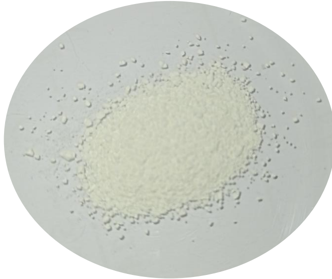
الشكل (5.III): جسيمات أكسيد الزنك النانوية بعد عملية الحرق.
