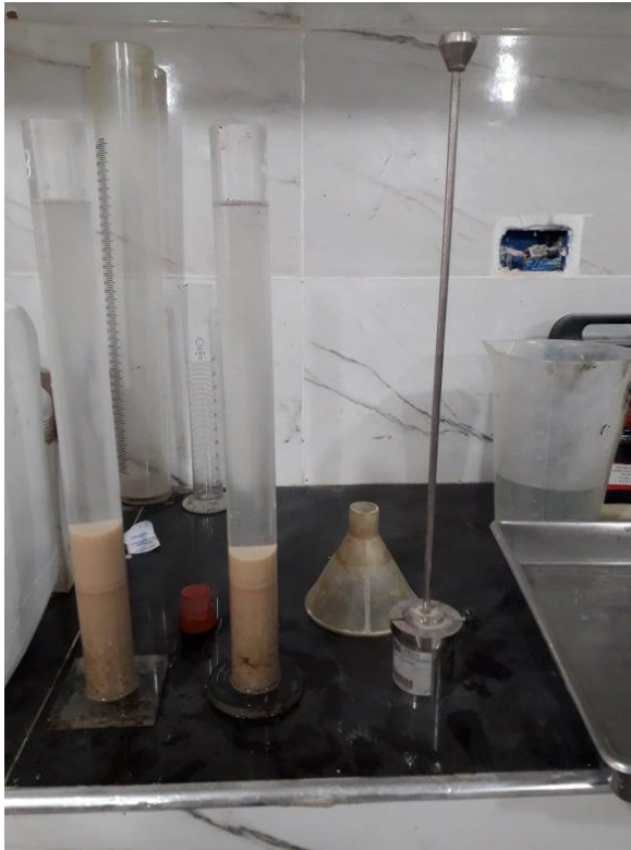
الصورة 3- III : توضح تجربة مكافئ الرملي بعد الرج و بعد عشرين دقيقة
