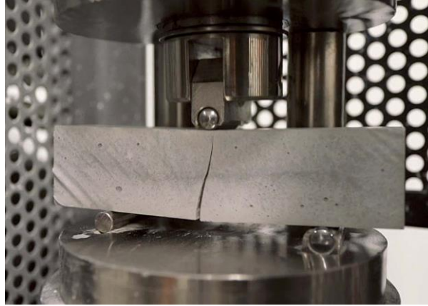
الصورة 3-I توضح وضع العينة داخل جهاز الشد بالانحناء بتعريض العينة لقوى واحدة مركزية.
