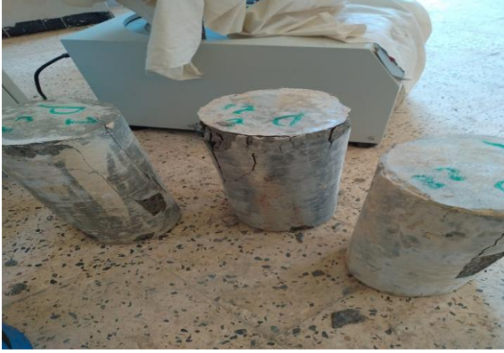
الصورة 4- عينات في حالة انهيار
