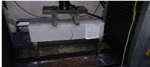
الصورة 4-I توضح وضع العينة داخل جهاز الشد بالانحناء وبتعريض العينة لقوتين مركزيتين.
