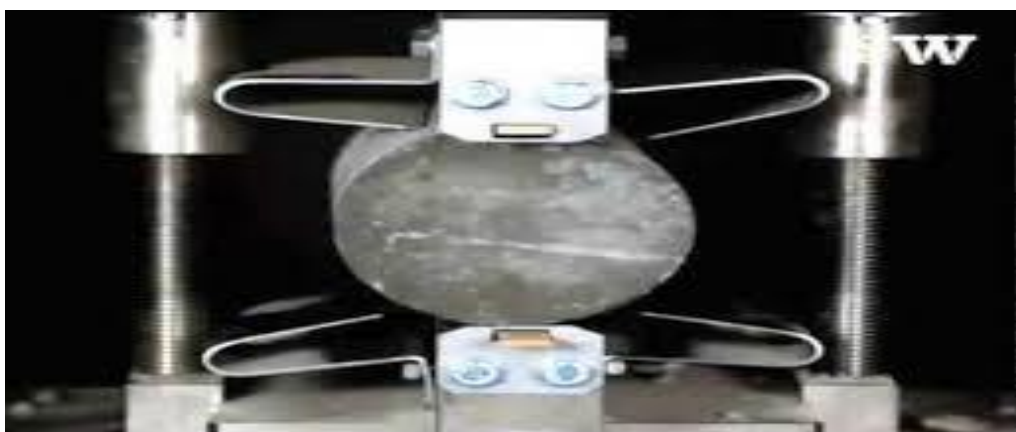
الصورة 2-2-3-2 توضح طريقة وضع العينة داخل جهاز الشد الغير مباشر.
