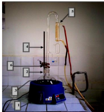
صورة (9) : جهاز التقطير المائي (Clévenger)
