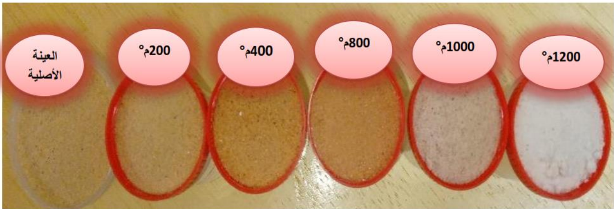
الشكل III-7: صورة توضح ألوان الرمل بعد التسخين
