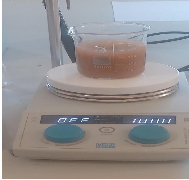
الشكل III-2: صورة توضح عملية الرج المغناطيسي
