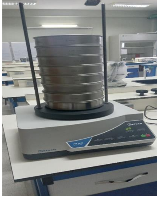
الشكل II-12: بعض الغرابيل المستعملة والهاز الكهربائي
