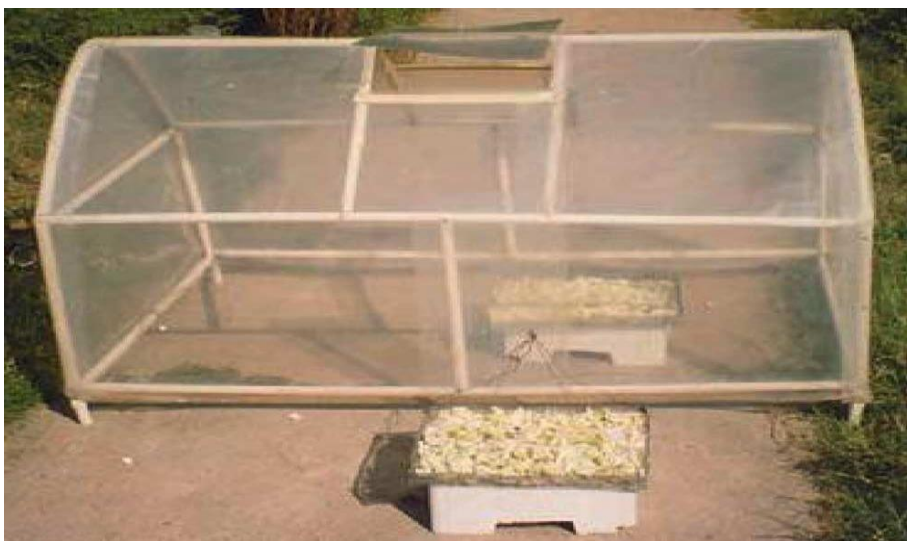
Figure II. 5 Configuration expérimentale pour le séchage en plein soleil et le séchage en serre en mode passif [15].
