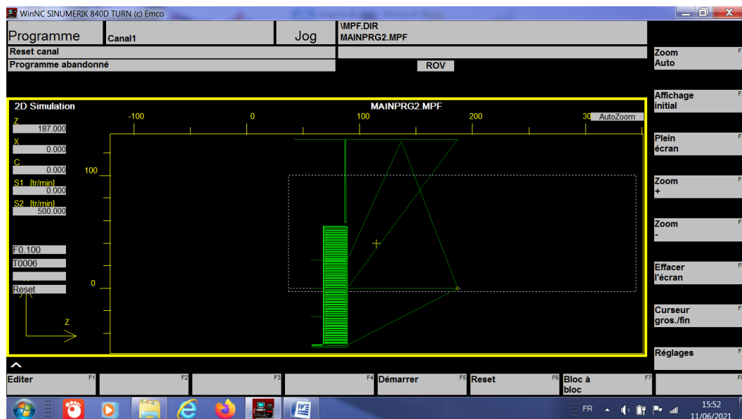
Fig. III.7 : Simulation du programme principale Master2.mpf lors de l'usinage de la face2, perçage du trou du centre, alésage du trou central étagé, la rangée des 6 trous \phi 16mm et la gorge du diamètre extérieur.
