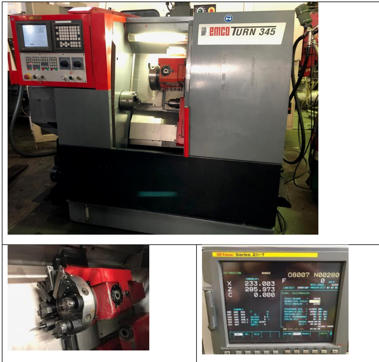
Fig. III.1 : Exemple d'un tour à commande numérique: EMCO PC Turn 345
