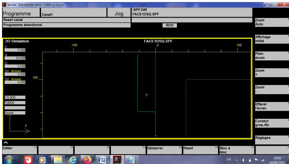
Fig. III.4 : Fenêtre du logiciel de commande Sinumerik WINNC 840D présentant la Simulation de la trajectoire de l'outil (couleur verte) pour l'usinage de la Face1dsq.
