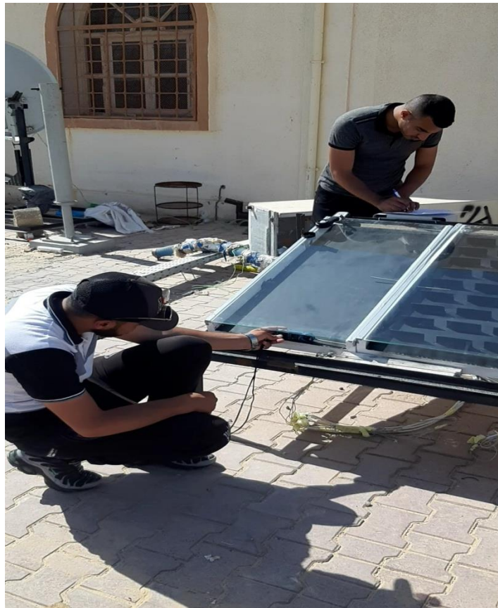
Photo III.23: Mesure de la vitesse d'entrée du capteur à l'aide d'un anémomètre.
