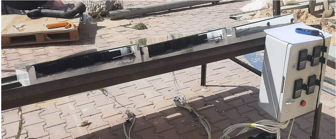
Photo III.17: Les capteurs solaires et l'armoire de mesure de température et le support.
